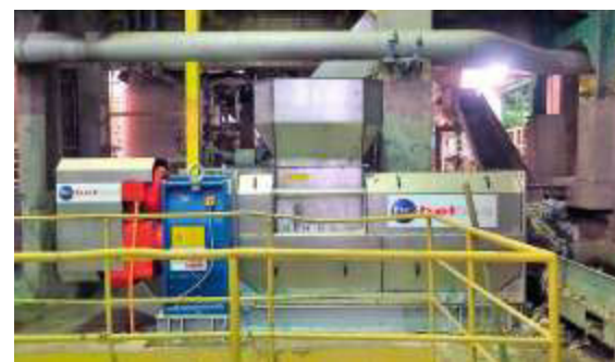
FAN BP 601, presse à vis à rejet-pulpeur pour DS Smith Belisce
